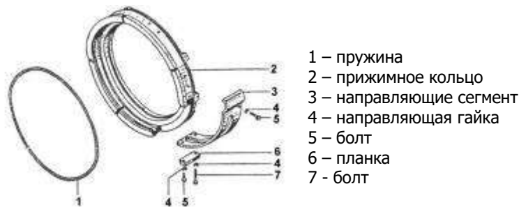
Рисунок 6. Канатоукладчик – развернутый вид.
