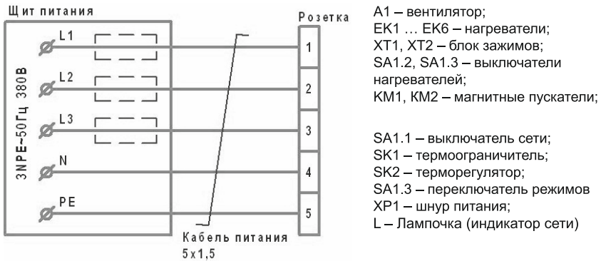
Рис.4 Схема подключения розетки к стационарной сети
