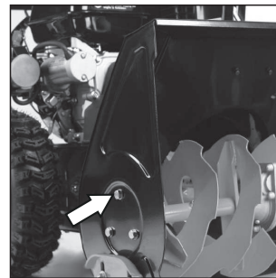
Шаг 10. Проверьте затяжку болтов опорных подшипников шнека.
