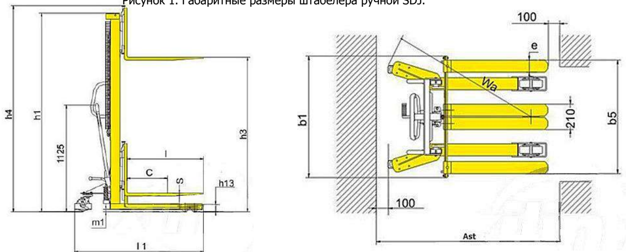
Рисунок 2. Габаритные размеры штабелера ручной SJA20E.
